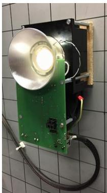
Notre système s'articule donc autour de 20 LEDs de puissance de 140W électrique chacune, montées sur des dissipateurs thermiques (photo ci-contre). Ces dernières ont un spectre d'émission plus adapté au panneau solaire (spectre d'émission continu, d'avantage centré sur le pic d'absorption des panneaux). En effet les panneaux solaires sont dans l'ensemble principalement sensibles aux fréquences dans le visible, et peu aux infra-rouge. En outre cela les chauffe et diminue ainsi leur rendement.
